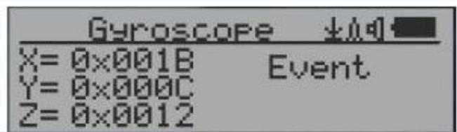
Der interne digitale Beschleunigungsmesser kann Gyroskopdaten in Echtzeit bereitstellen. Es zeigt die aktuellen Daten der X-, Y- und Z-Achse sowie das erkannte Bewegungsereignis an. Wie einfaches oder doppeltes Antippen.
