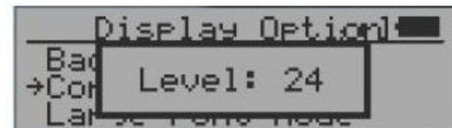
Verwenden Sie S2 und S3, um den Kontrast einzustellen. Die Kontraststufe wird gespeichert und beim Wiedereinschalten verwendet.
