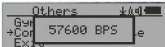
Die serielle Kommunikations-Baudrate des Geigerzählers kann aus folgenden Werten ausgewählt werden: 1200, 2400, 4800, 9600, 4400, 19200, 28800, 38400, 57600, 115200. Drücken Sie die Taste S4, um die Baudrate zu ändern.
