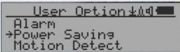
Durch Drücken der Taste S4 wird der Stromsparmodus ein- und ausgeschaltet.
