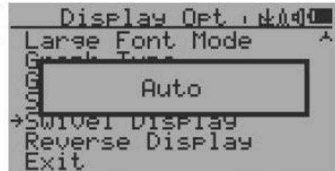
Durch Drücken der Taste S4 wird zwischen den folgenden Modi gewechselt: Normal -> Schwenken -> Automatisches Schwenken
